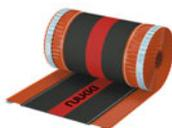
Однослойная вентиляционная лента для всех видов коньков. Изготовлена из профилированного алюминиевого листа, полипропиленовой ткани и самоклеющейся бутиловой ленты. Дополнительным укреплением соединения алюминиевого листа и полипропиленовой ткани является шитье специальной нитью.
