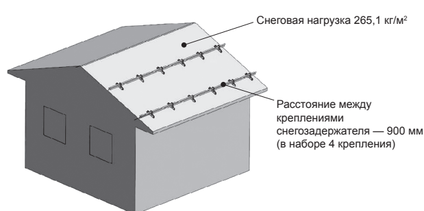
Максимальная длина ската над снегозадержателем — 3,3 м
