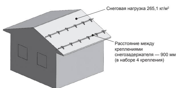
Максимальная длина ската над снегозадержателем — 3,3 м
